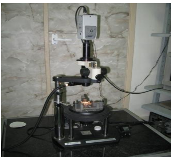
9 Сурет - «Solver-M» NT-MDT Атомдық күштік микроскоптың сыртқы кескіні
