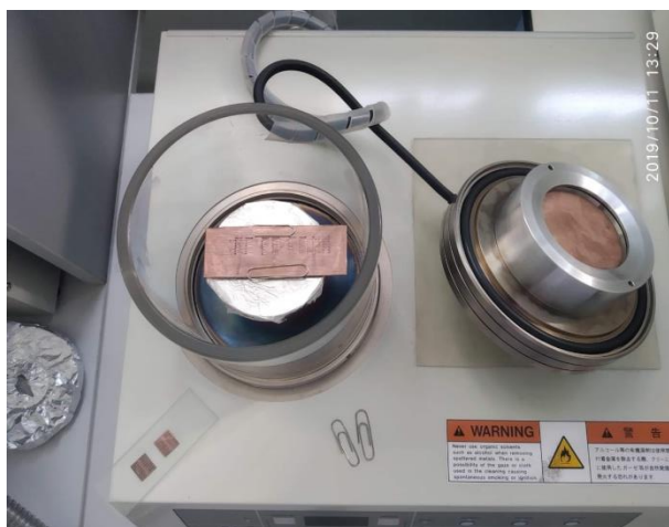
16 Сурет - Өткізгіш қабаттарын маска арқылы қондыру процесі
